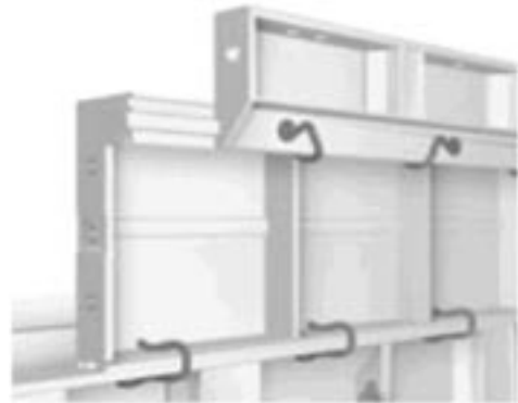
Figura 18a. Disposición pin grapa.
